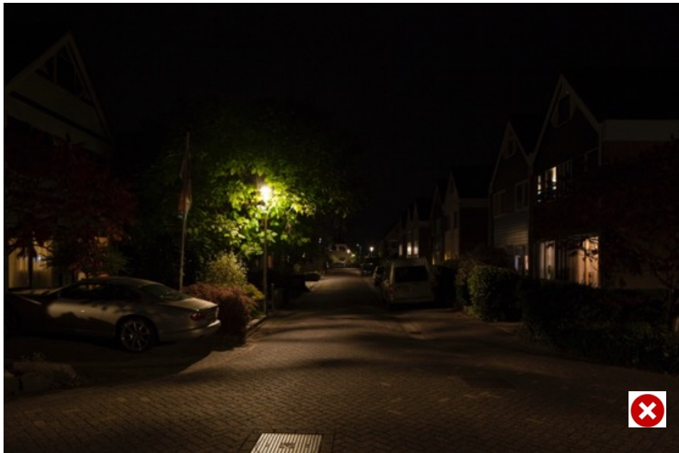
Foto: Lantaarnpaal staat in de boom en geeft niet voldoende licht meer op de weg daardoor. Door goede afstemming kan dit voorkomen worden.
